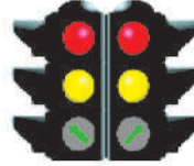
ပုံ ၂၉၅ လမ်းလေးခုထက်ပို၍ဆုံနေသော လမ်းဆုံတွင် မီးစိမ်းအစား မြားပုံမီးစိမ်းတပ်ဆင်အသုံးပြုပုံ
